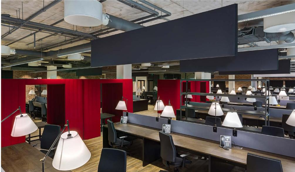
*Salle de cours, USA. Baffles acoustiques. Dim. : 0,60 m x 2,80 m. Revêtement couleur et absorbant acoustique.*
